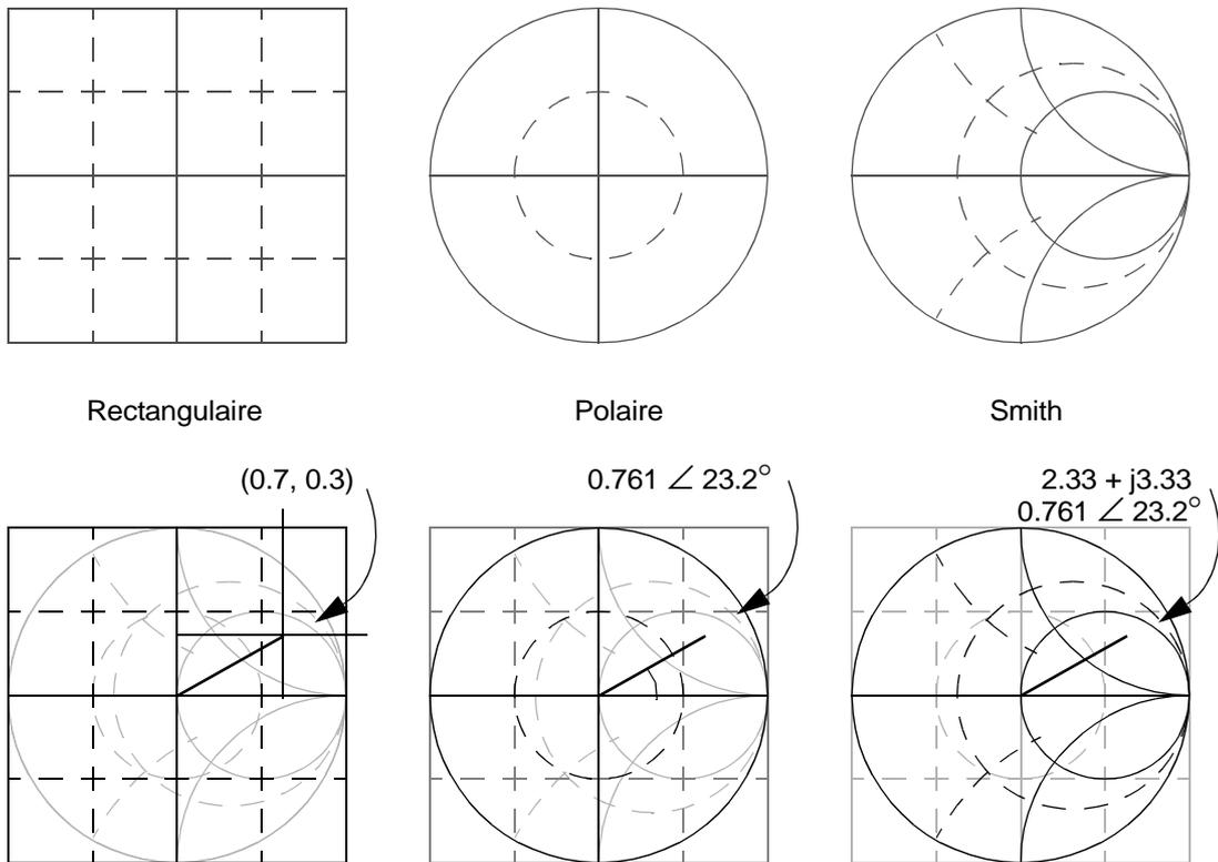
Une observation intéressante est que si l'on utilise des paramètres normalisés, les trois graphes peuvent être superposés, comme représenté sur les 3 figures ci-dessus, et le même vecteur peut y être lu de différentes manière sur leurs axes respectifs.
