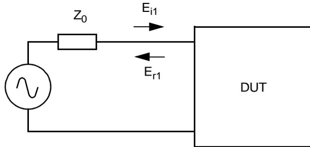
La tension dans le DUT est composée de 2 éléments, une onde directe  $E_{i1}$  et une onde réfléchie  $E_{r1}$  caractérisées par une tension et un courant :
