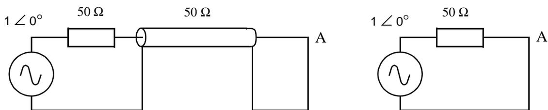
On observe que la tension en A est de zero et que le courant y est de :  $\frac{1\angle 0}{50} = 20\angle 0 \text{ mA}$ .
