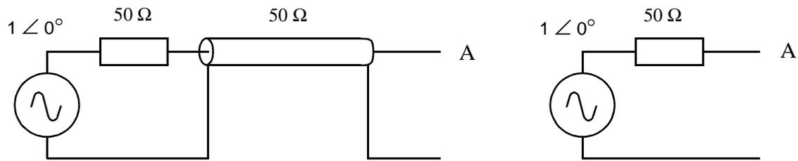
On observe que la tension en A est de  $1 \angle 0$  V et que le courant y est de 0.
